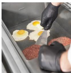
Possibilité de contrôler 2 zones distinctes à des températures différentes. 5 éléments chauffants blindés à haute résistance thermique, qui maintiennent une température uniforme et stable sur toute la surface.
