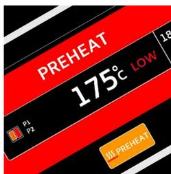
La fonction PREHEAT permet de préchauffer la plaque de cuisson afin de cuire les aliments de manière réactive. En réglant une température de consigne, l'appareil réglera un delta de température plus élevé pour compenser l'abaissement dû au positionnement des aliments
