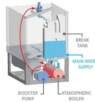
PLUS SYSTEM Rinçage à température et pression d'eau constantes
