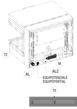
AL\_ Entrata cavo elettrico | Power supply cable inlet | Netzkabeleingang | Entree cable électrique | Entrada cable electrico.
