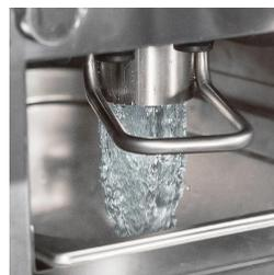
Becken zum Ablassen des gekochten Produkts in den Tank. Garantierte Sauberkeit der Station und einfacher Transport der Produkte.
