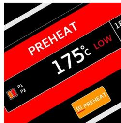
Mit der Funktion PREHEAT kann die Kochplatte vorgeheizt werden, um die Speisen reaktiv zu garen. Durch die Einstellung einer Solltemperatur stellt das Gerät ein höheres Temperaturdelta ein, um die durch die Positionierung der Speisen bedingte Absenkung zu kompensieren
