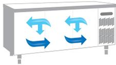
L'uniformità della temperatura in tutto il vano refrigerato è garantita da un sistema di ventilazione brevettato che prevede la canalizzazione dell'aria anche grazie all'assenza dell'evaporatore in cella.
