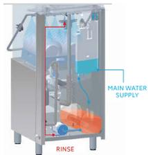
Rinçage à pression stabilisée et température constante de l'eau de la chaudière de 85°C. Grâce à la chaudière atmosphérique, le mélange de l'eau du réseau dans la phase de rinçage est évité. Le système PLUS permet également un meilleur contrôle et un dosage correct du produit de rinçage à chaque cycle.
