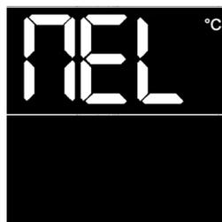
MELTING-Funktion für die Verwendung von festem oder halbfestem Fett, integriert in die Touch-Steuerung.
