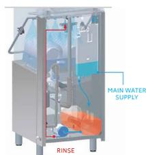
Stabilisierte Druckspülung und konstante Kesselwassertemperatur von 85°C. Dank des atmosphärischen Boilers wird eine Vermischung des Leitungswassers in der Nachspülphase vermieden. Das PLUS-System gewährleistet außerdem eine bessere Kontrolle und die richtige Dosierung des Klarspülers bei jedem Zyklus.
