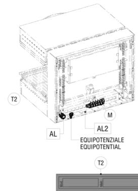
AL\_ Entrata cavo elettrico | Power supply cable inlet | Netzkabeleingang | Entree cable électrique | Entrada cable electrico.
