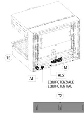
AL\_ Entrata cavo elettrico | Power supply cable inlet | Netzkabeleingang | Entree cable électrique | Entrada cable eléctrico.
