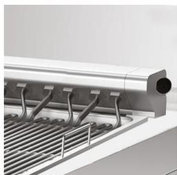
Die Heizelementbaugruppe ist auf einem Kippträger montiert und wird durch einen Arretierstift in der Arbeits- oder Reinigungsposition gehalten.
