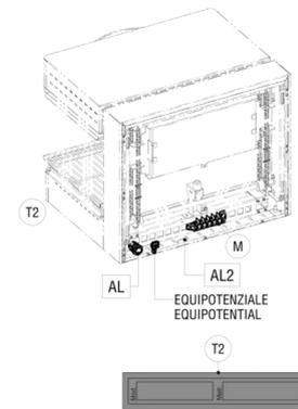
AL\_ Entrata cavo elettrico | Power supply cable inlet | Netzkabeleingang | Entrée cable électrique | Entrada cable eléctrico.
