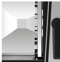
Hinterlüftete, doppelt verglaste Hartglastür mit Luftspalt und wärereflektierendem Innenglas für geringere Wärmeabstrahlung zum Bediener und höhere Effizienz.
