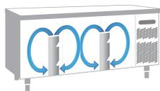
Evaporadores situados detrás de cada montante de la puerta para garantizar una distribución uniforme del frío.
