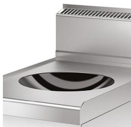
Ein Gerät erkennt das Vorhandensein der Pfanne und schaltet die Heizung ein; bei abnormalem Gebrauch blockiert jedoch eine spezielle Überhitzungsschutzvorrichtung den Betrieb.
