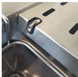
Der Wasserspender befindet sich an der Vorderseite des Tanks.
